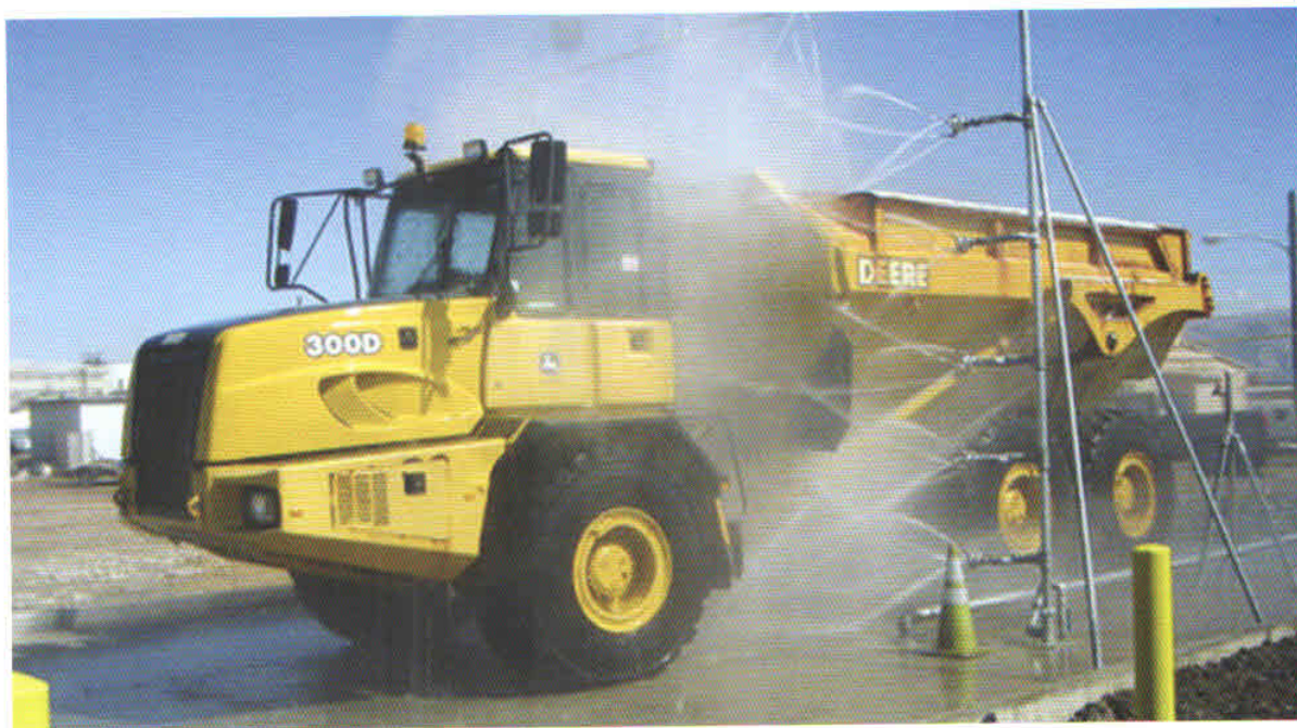
Машин механизмын дугуй угаах 1-р арга: Зөөврийн автомат тоног төхөөрөмж ашиглан усаар тоос шороог шүршиж арилгах
