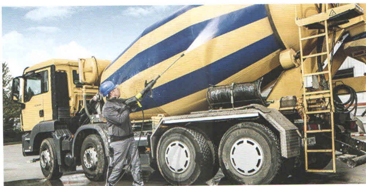
Машин механизмын дугуй угаах 2-р арга Механик гар аргаар даралтат усаар тоос шороог шүршиж арилгах
